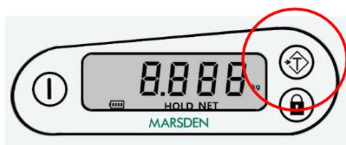
Vekten har også en Auto-off funksjon. Du kan endre tiden for Auto-off ved å holde inne TARE i 8 sekunder, og bruke HOLD knappen for å bytte mellom alternativene.
